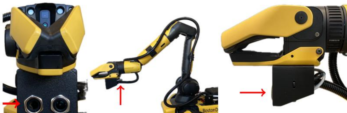
Figur 13. Värmekameras placering på Spot.
