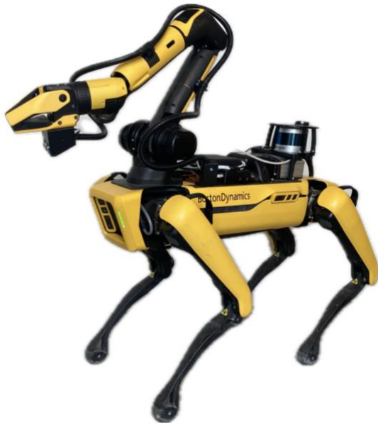
Figur 10. Robot Spot utrustad med värmekamera monterad i arbetspaketet. Kameran är monterad under robotarmens grippdon och förbunden med en kamera-controller med kabelföring längs robotarmen. Syftet med monteringen är att tillåta "svepande" armrörelser för att öka synfältet.
